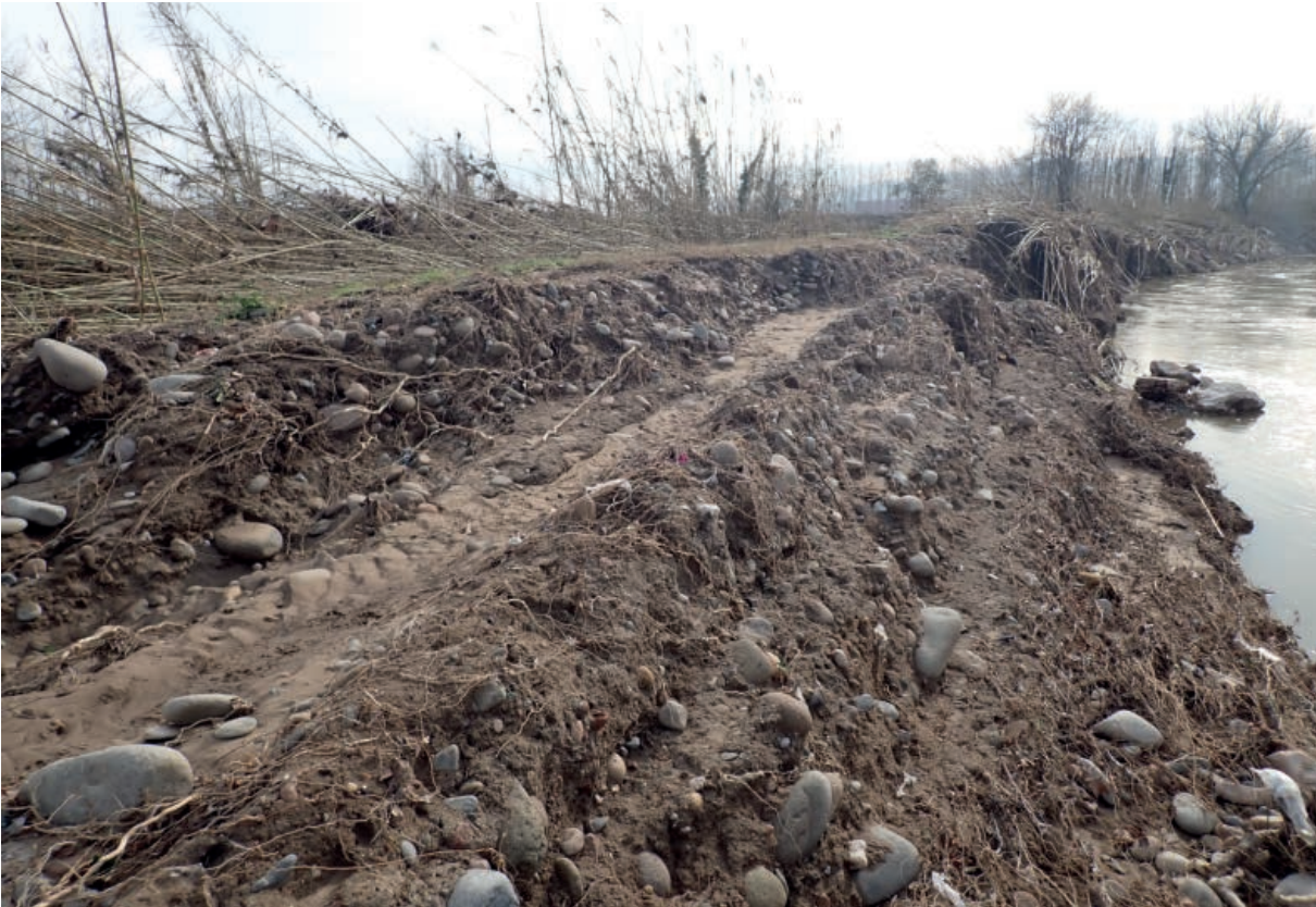
Fotografia 39. Soscavació a la riba dreta del Ter. Escarpament d'erosió lateral de més de 2 m d'alçada. Dipòsits de terrassa format per graves rodades, sorres i llims. Sector entre Medinyà i Celrà.
