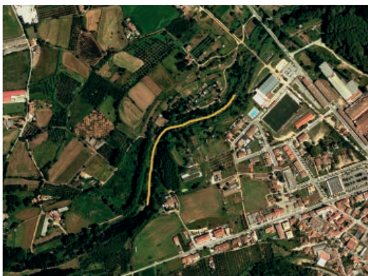
Figura 33. Imatge de l'ortofotomapa en color 1:5 000 de 2019 del tram baix de la Riera d'Osor on el curs fluvial es va bifurcar produint el trencament del camí que va d'Anglès a Osor. En color groc s'indica el curs fluvial natural de la riera abans del temporal.
