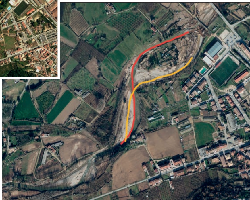
Figura 34. Imatge del vol de l'ICGC just després del temporal on s'observen els efectes geomorfològics causats pel Gloria, entre ells el canvi de curs fluvial. En color groc s'indica el curs fluvial abans del temporal i en color vermell el curs fluvial després d'obrir-se pas trencant el camí.
