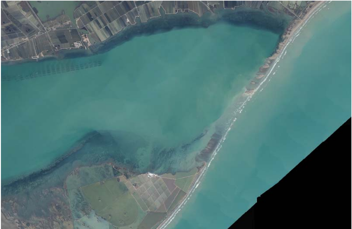
Figura 16. Ultrapassament de la barra del Trabucaador durant la borrasca Glòria. Les fortes onades i una sobreelevació del nivell del mar de gairebé 50 cm van afavorir aquest fenomen (imatge de l'Institut Cartogràfic i Geològic de Catalunya).
